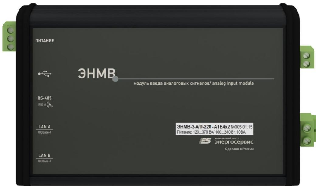
Рисунок 1.2. Лицевая панель модуля аналогового ввода ЭНМВ-3.
