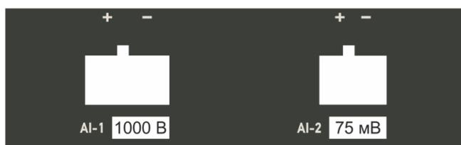
Рисунок 8.2. Шильдик боковой крышки (на примере ЭНМВ-3-A/D-X-A1E4x2).
